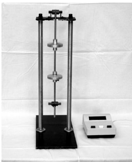
Рис. 5.3. Установка для определения ускорения свободного падения методом оборотного маятника
